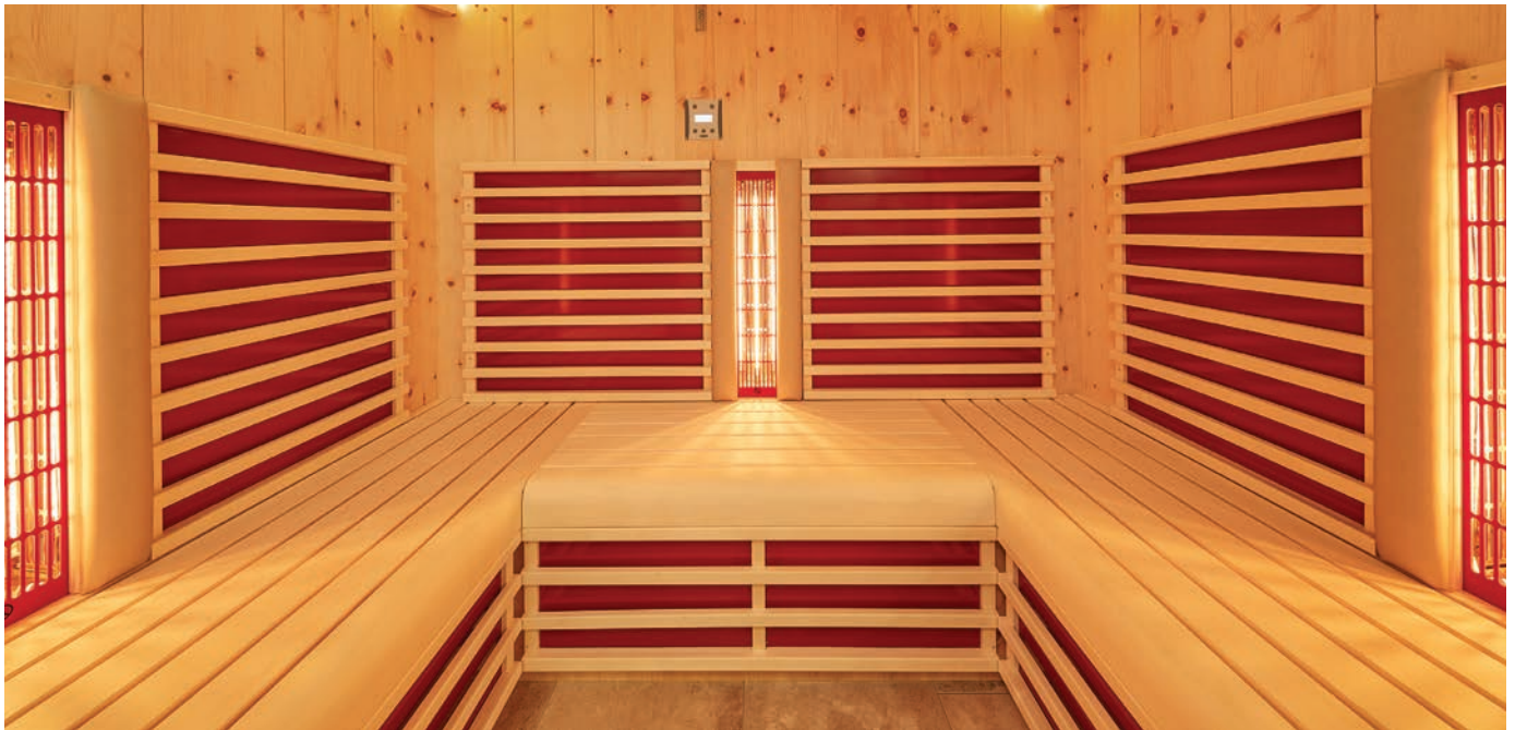
Detail: Innenwände verkleidet mit großen Paneelen aus Zirbenholz. 3 VITAllight-IPX4-Infrarotstrahler mit Einzelplatzregelung.
